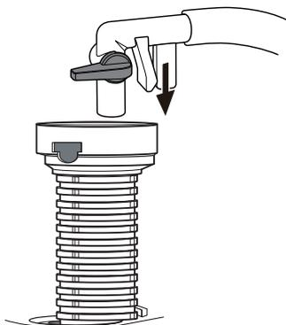
2. 进水阀上与补水软管连接的调节器卡到排水阀溢水管上端。
