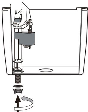
1. 将进水阀底部螺牙端插入水箱进水阀安装孔内，依次装入垫片旋上螺母，并确认螺母是否有旋紧。
