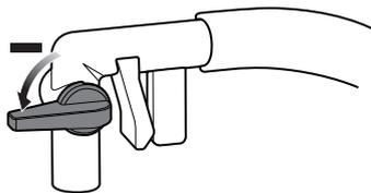
6. 逆时针旋转补水调节器旋钮可减少补水量
