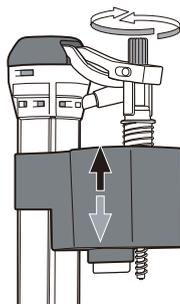
4. 顺时针或逆时针旋转调节螺杆，使进水阀浮筒上下移动微调水位高低。
