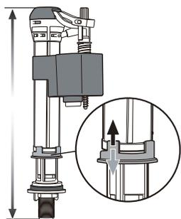
3. 往下松开图示中的防转扣环，顺时针转动本体，调整进水本体和调节管相对位置高度到合适的水位高度，逆时针旋转本体并将防转扣环往上推到固定位置。
